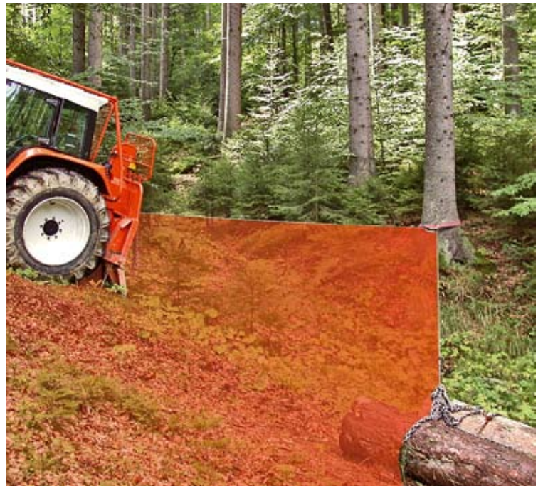
Gefahrenbereiche im Seilwinkel aber auch...
